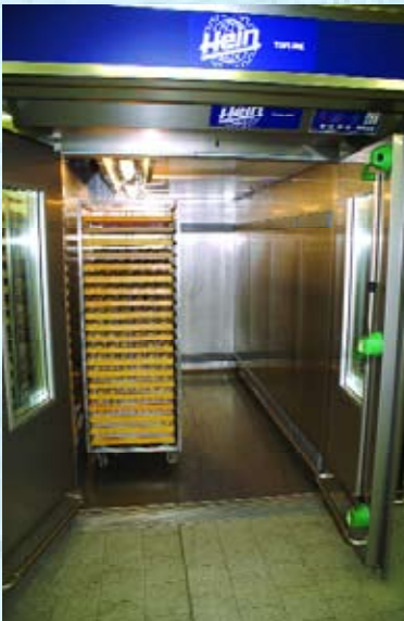
Der Top-Lux Gärvollautomat bietet Platz für sechs Stikkenwagen.
