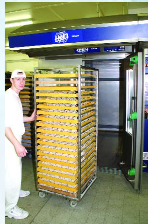
Am Morgen wird der Gärvollautomat wieder mit Brötchen befüllt. Die Aufarbeitung erfolgt rationell über eine Kombi-Brötchenanlage.
