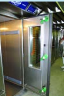
Die neuen Türverschlüsse sorgen für ein dichtes Schließen der Türen.
