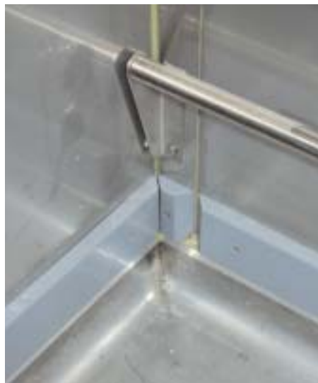
Der hochgezogene, geschweißte 3 mm starke Edelstahlboden garantiert Langlebigkeit. Er wird serienmäßig beheizt.
